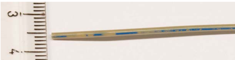
Figur 8. PEEK-slang. 0,25 mm innerdiameter  r standard. Foto: Bj rn Gunnarsson.
