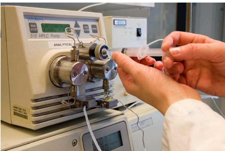
Figur 9. Utsugning av mobilfas genom purge-ventilen. Foto: Bj rn Gunnarsson.
