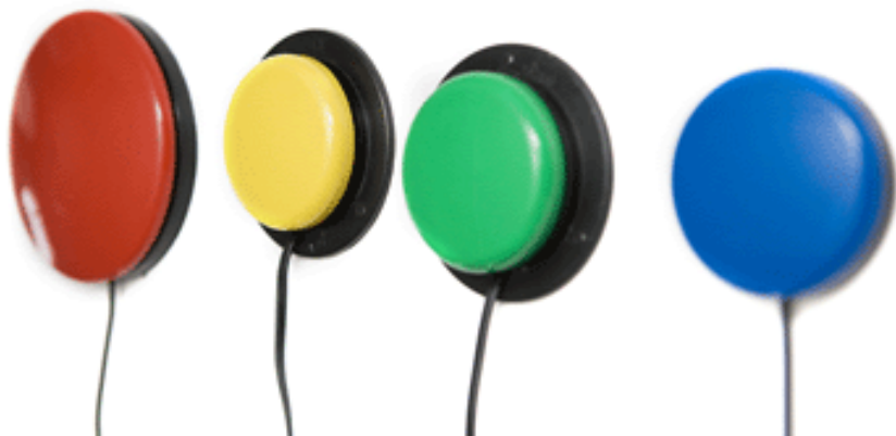
Figur 2. Brytarkontakter i olika färger. Genom att trycka på en brytare kan olika händelser styras. I musikaliska sammanhang styr musikanten olika ackord eller toner som finns exempelvis på en synthesizer eller i en dator.
