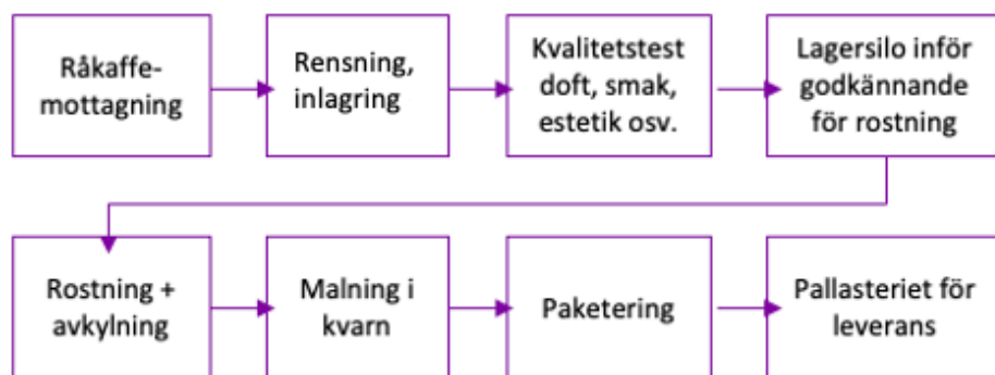
Figur 1. Förenklat flödesschema för kaffets behandling.
